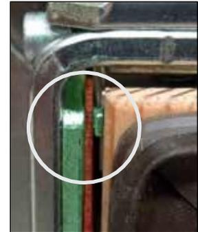
**Messstreifen der Fühlerlehre muss im Prüfspalt Platz finden, ansonsten wurde das minimale Einstellmaß unterschritten!**
